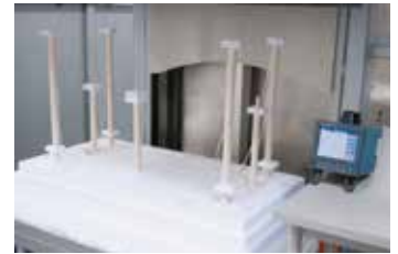
Messaufbau in einem Hochtemperaturofen
