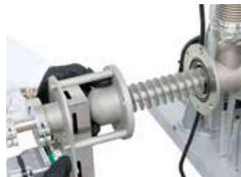
Förderschnecke mit einstellbarer Drehzahl
