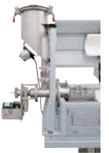
Vibrationsgenerator am Einfülltrichter für bessere Pulverzufuhr
